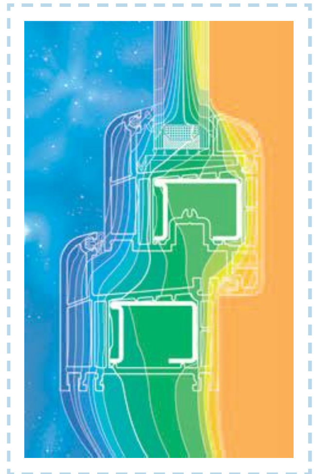
Termografía de una sección de ventana con perfiles Kömmerling.
